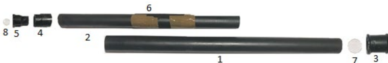
Figura 1 - Esquema para montagem de um telescópio refrator kepleriano
